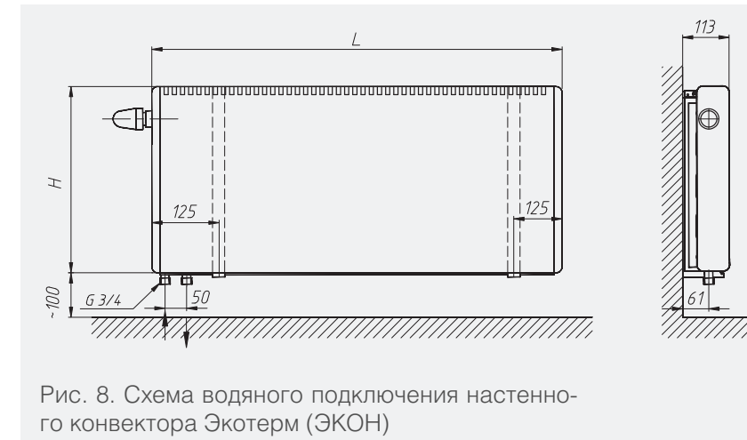
Рис. 9. Узел подключения конвектора Экотерм
