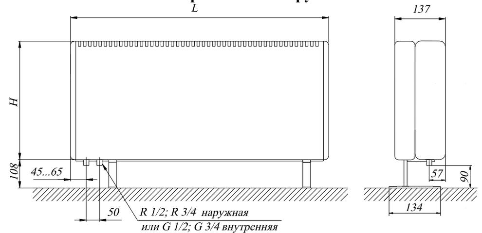
**Рис. 2 Конвектор РКОН монтируемый к полу.**
