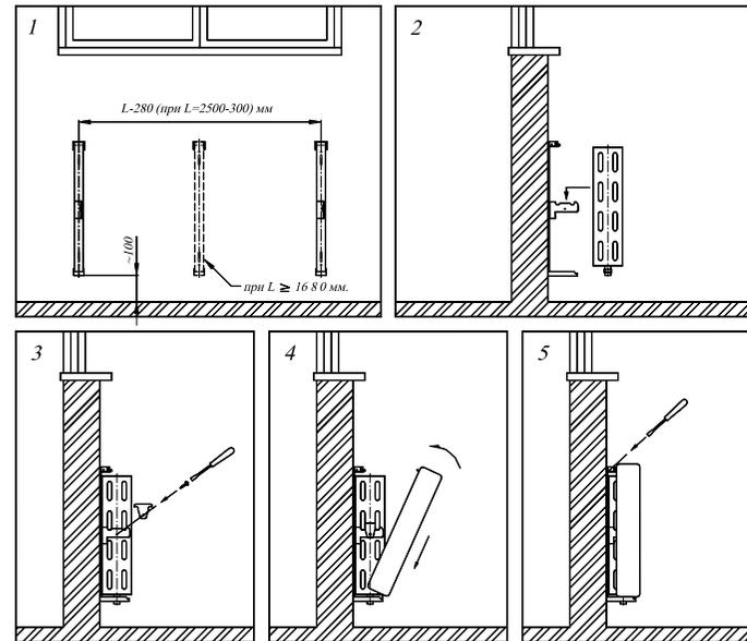
Рис. 4 Последовательность монтажа конвектора на стене.
