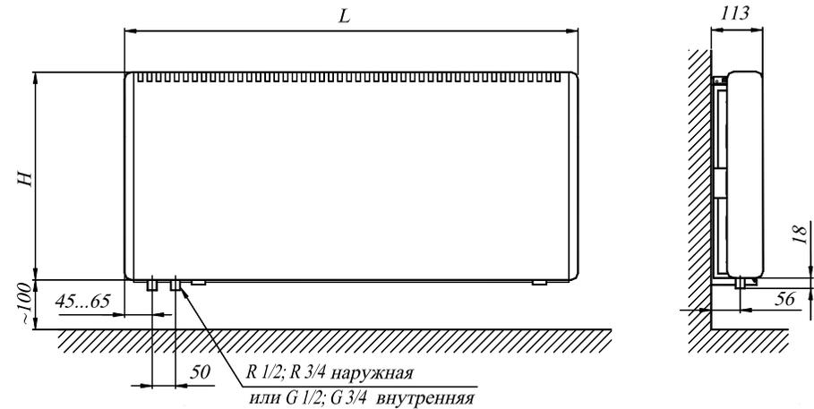
**Рис. 1 Конвектор РКНН монтируемый к стене.**
